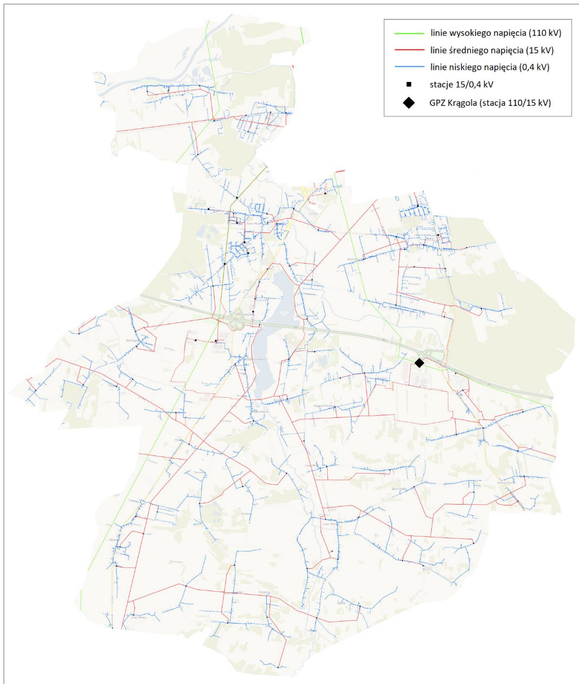
Rysunek 5. Schemat dystrybucyjnego systemu elektroenergetycznego ENERGA-OPERATOR S.A. na terenie gminy Stare Miasto
