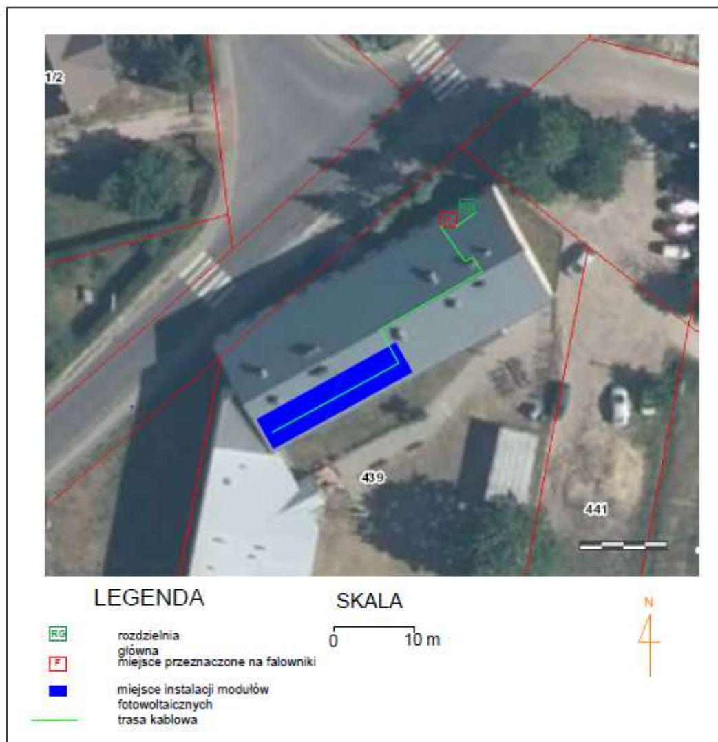
Rys. 6. Lokalizacja falownika, rozdzielni głównej oraz przebieg trasy kablowej
